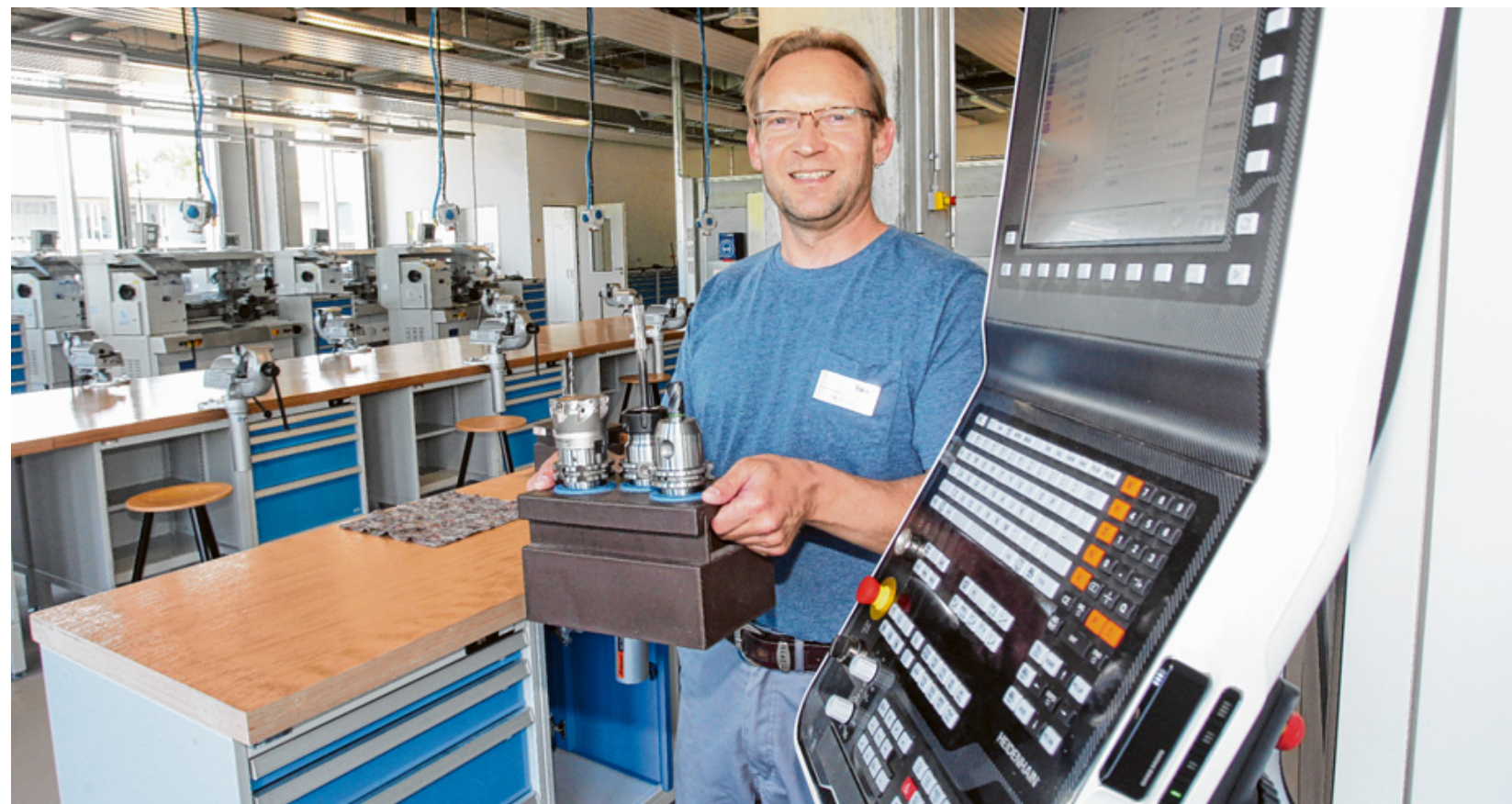
Blick in den Lehrsaal für Feinmechaniker: Roland Pisch steht am Steuerungspult einer Universalfräsmaschine für die Fünf-Seiten-Bearbeitung und zeigt Werkzeugaufsätze für die Fräsmaschine. Fotos: Annette Zoepf
